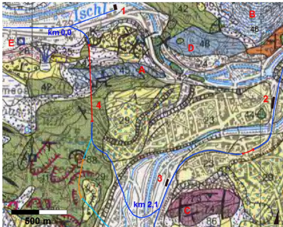
Abb. 3: Ausschnitt aus der geol. Karte Blatt 96 Bad Ischl (Schäffer, 1982) mit den errichteten Bahnstrecken (blau), Tunneln (rot) und der nicht realisierten Variante (türkis) mit zusätzlichem Tunnel (orange). 1 – Lokalbahnstahns, 2 – Staatsbahnhahns, 3 – Güterbahnhahns, 4 – Kalvarienbergstahns, relevante Signaturen der geologischen Karte: 23 – Terrassenschotter, 26 – Kames und Osschotter, 29 – Eisrandstaukörper, 42 – Gosauergel und Gosaukonglomerat, 45 – Bunter Oberjurakalk, 46 – Plassenkalk, 48 – Oberalmer Schichten, 73/74 – Hallstätter Kalke, 88 – Haselgebirge, im Text erwähnte Örtlichkeiten: A – Kalvarienberg, B – Jainzen, C – Siriuskogel, D – Kaiserpark, E – Maria-Louisen-Quelle
