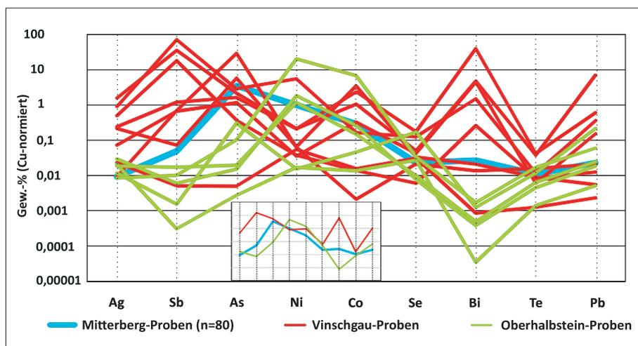
**ABB. 5:** Spiderdiagramm mit den Cu-normierten Gehalten an ausgewählten chemischen Elementen in den untersuchten acht Proben aus dem Vinschgau, fünf erzhaltigen Gesteinsproben aus dem Oberhalbstein-Tal und 80 vom Mitterberg-Revier (Pernicka et al. 2016; Reitmaier-Naef et al. 2020). Das Miniaturdiagramm stellt für alle drei Lokalitäten die Durchschnittswerte dar (Grafik: M. Bode).
