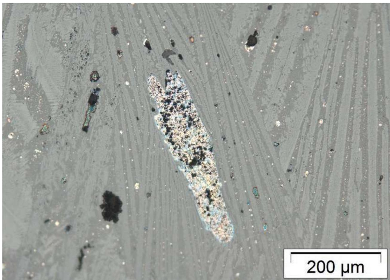
**ABB. 7:** Mikroskopaufnahme der Pr. 11 vom Schmelzplatz Prad-SP 1. Das Mikrogefüge der Plattenschlacke wird von langstängeligen Olivinen (Fayalite, hellgrau) dominiert. Dazwischen sind Kupferstein (gelb-bläulich) und gelegentlich Magnetite in die Schlackenmatrix (dunkelgrau) eingelagert (Foto: M. Mehofer, Universität Wien).
