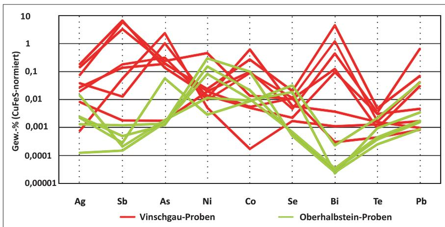
**ABB. 3:** Spiderdiagramm mit den CuFeS-normalierten Gehalten an ausgewählten chemischen Elementen in den untersuchten Proben aus dem Vinschgau und fünf erzhaltigen Gesteinsproben aus dem Oberhalbstein-Tal (Reitmaier-Naef et al. 2020) (Grafik: M. Bode).
