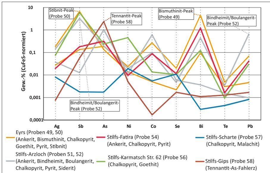
**ABB. 2:** Spiderdiagramm mit den CuFeS-normalierten Gehalten an ausgewählten chemischen Elementen in den untersuchten Proben aus dem Vinschgau. Das Erzmineral Bismuthinit in Probe 49 wurde durchlichtmikroskopisch detektiert (Grafik: M. Bode).
