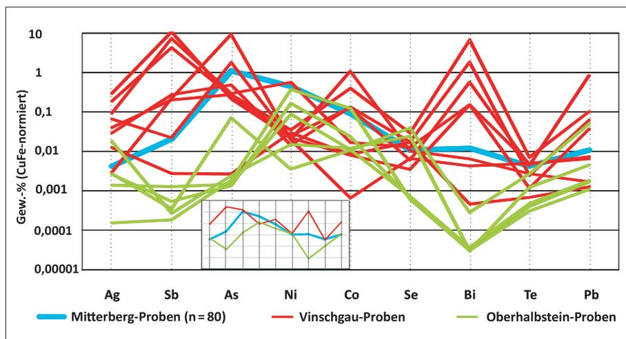
**ABB. 4:** Spiderdiagramm mit den FeCu-normierten Gehalten an ausgewählten chemischen Elementen in den untersuchten acht Proben aus dem Vinschgau, fünf erzhaltigen Gesteinsproben aus dem Oberhalbstein-Tal und 80 vom Mitterberg-Revier (Pernicka et al. 2016; Reitmaier-Naef et al. 2020). Das Miniaturdiagramm stellt für alle drei Lokalitäten die Durchschnittswerte dar (Grafik: M. Bode).
